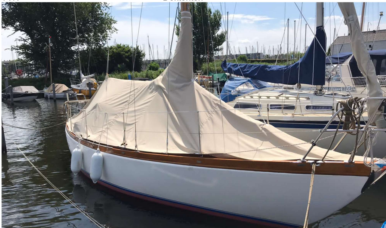
Dektent Trintella 1A-BN443-Doarmer van Reindert Bruin Gemaakt door / Made by de Vries in Enkhuizen
