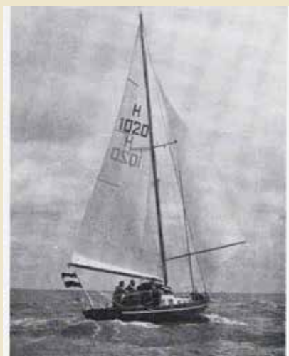
H 1020 SLAINTE II. Jachthek Masttopsliep. Eig.: Ir. F. A. A. Daamen. Kampen. Ontw.: E. G. v. d. Stadt. Bouwer: A. Wever. Orthen 1965. l.o.a. 10,35 m. b.o.a. 2,85 m. l.w.l. 7,35 m. Diepgang 1,45 m. zeilopp. 58 m 2 . water- verpl. 6,5 t. Staal. t.c.f. 0.7454. Albin 20 pk.
