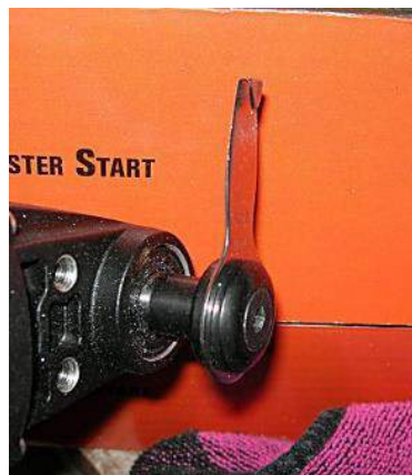
afb. 5 Fein mesje voor verwijderen rubber
