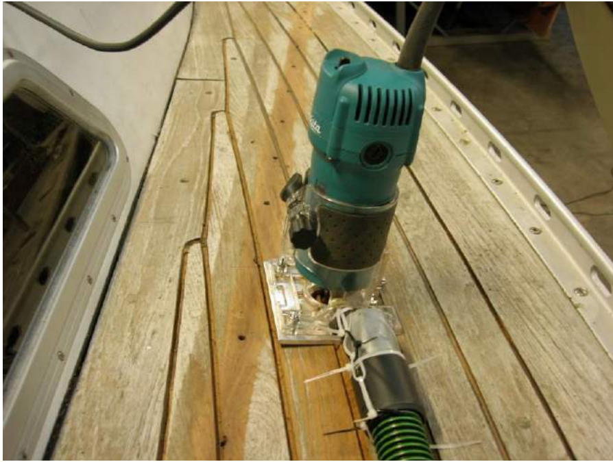
Afb. 11 Frees met stofzuigerslang, voor afzuigen materiaal
