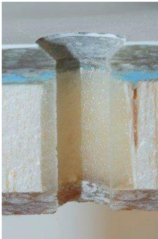
Afb. 6. Een opgepot gat en opnieuw geboord
