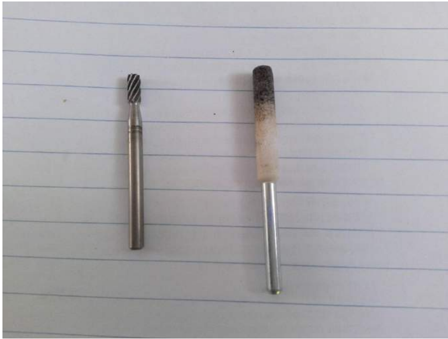
Afb. 13 Dremel frees (3,2 mm) en slijpsteentje (4 mm)
