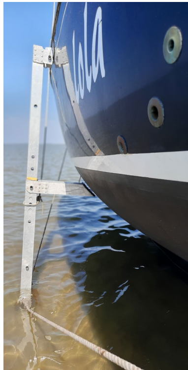
Inschuifbare wadpoten. De bevestiging van de poot aan de rompplaat is door middel van een alu-blok dat met een bout aan de knobbel van de plaat wordt bevestigd. Zie verder onderstaande tekening.
