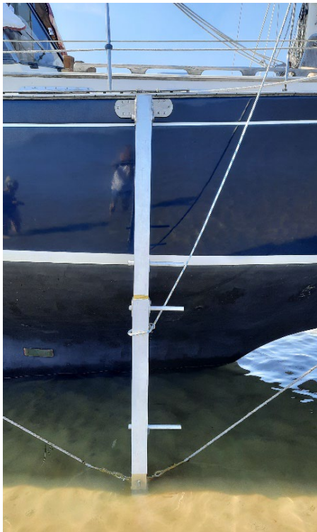
Inschuifbare wadpoten. De bevestiging van de poot aan de rompplaat is door middel van een alu-blok dat met een bout aan de knobbel van de plaat wordt bevestigd. Zie verder onderstaande tekening.
