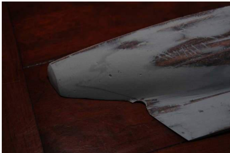
Figuur 8: De kont bleek het lastigst en kostte flink wat plamuurwerk
