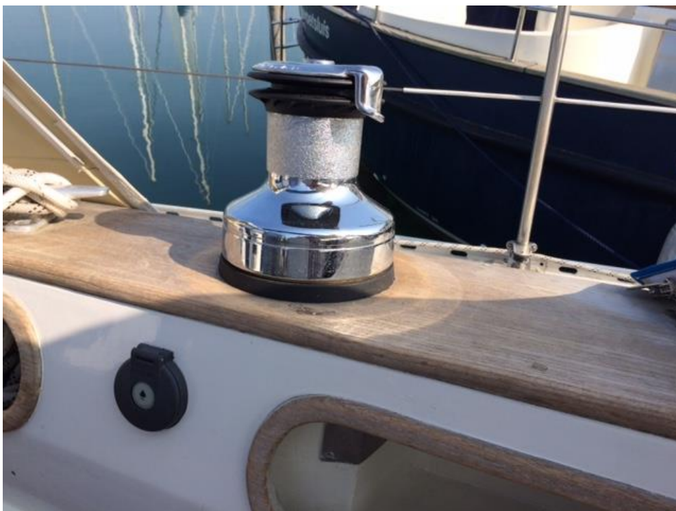
De elektrisch schootlier Lewmar EVO 50 met bedieningsknop
