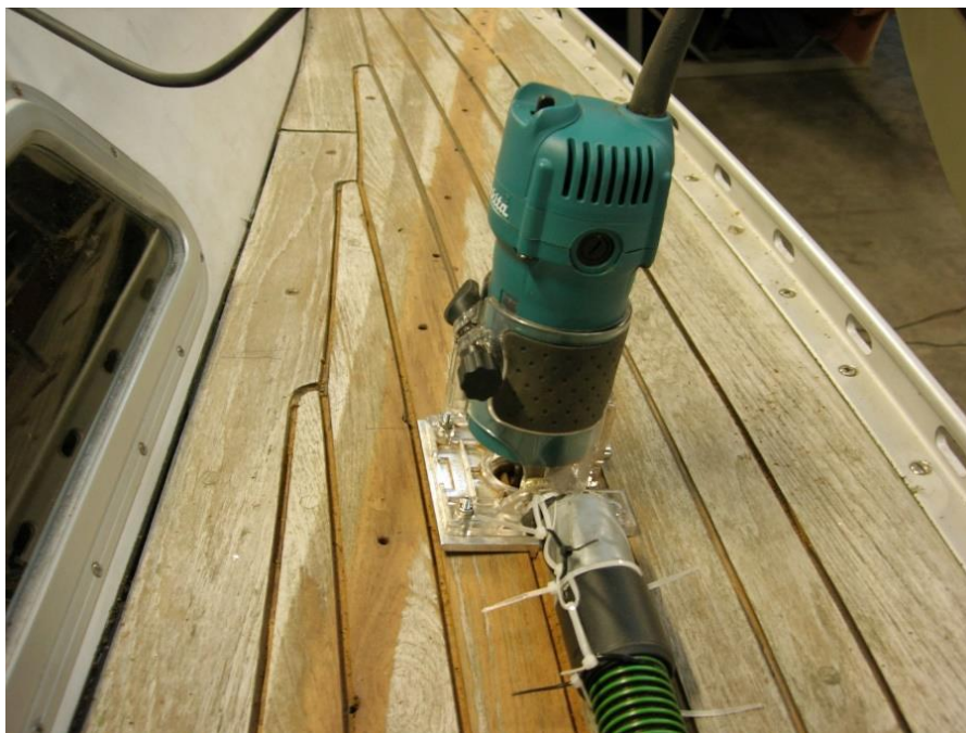
Afb. 11 Frees met stofzuigerslang, voor afzuigen materiaal
