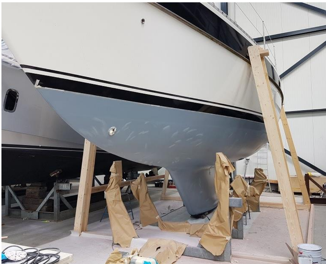
Ondersteund door balken door de ramen, zo is de romp vrij voor het schilderwerk
