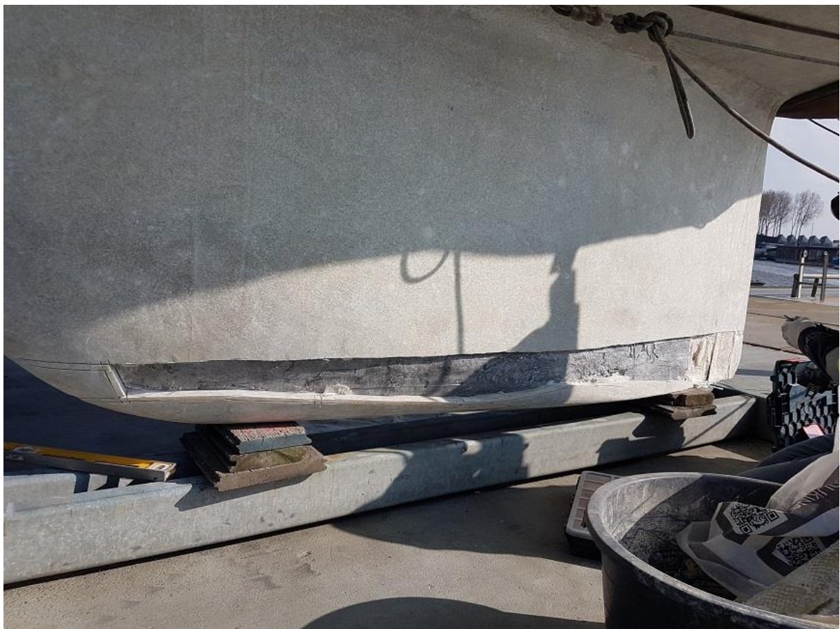
Het verwijderen van het polyester 12 cm boven de toekomstige zaaglijn in het lood.
