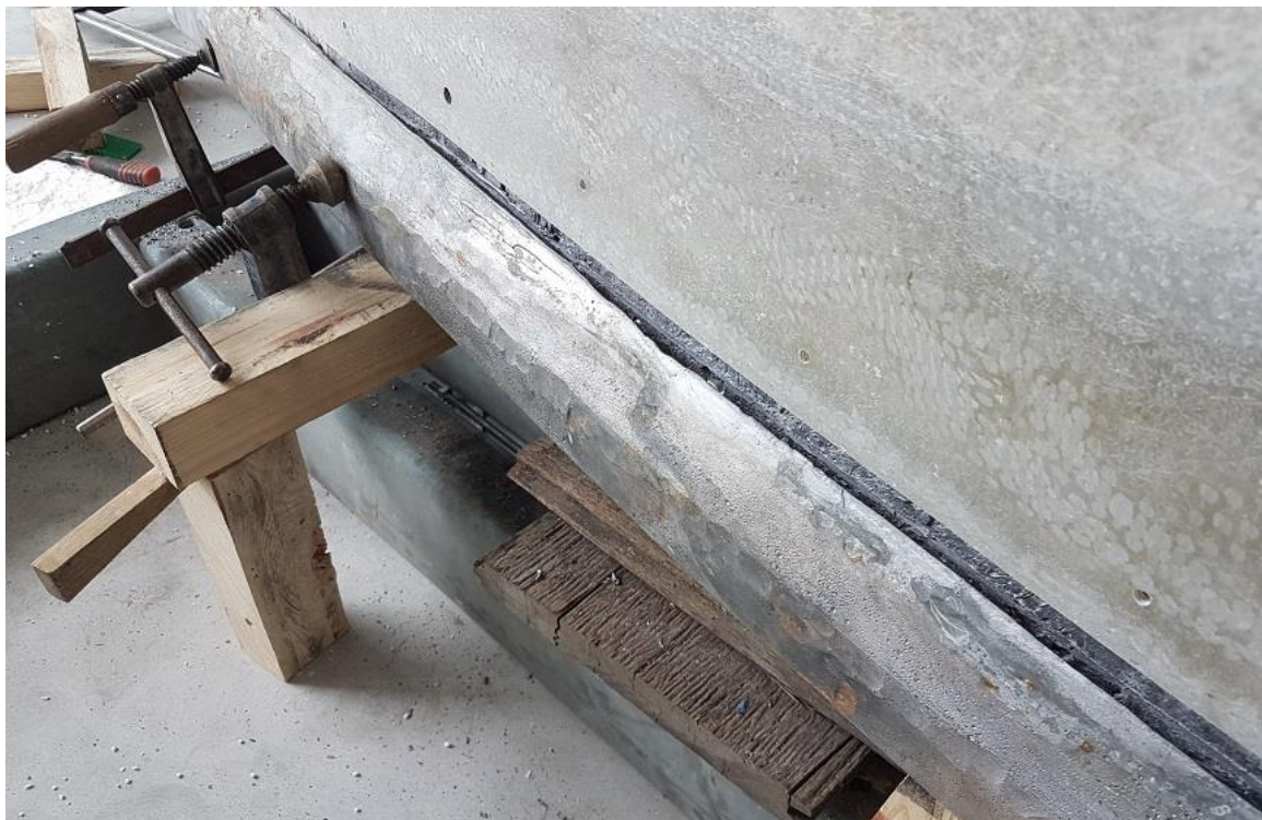
Loden strips aan weerszijden van de kiel in de vorm brengen en verlijmen
