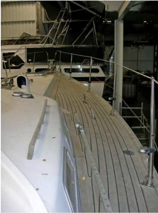
Afb. 1 Stuurboord kant, met puttings, scepterpotten, genuarail, handgrepen en watervuldop
