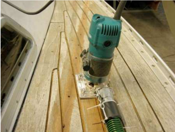
Afb. 11 Frees met stofzuigerslang, voor afzuigen materiaal
