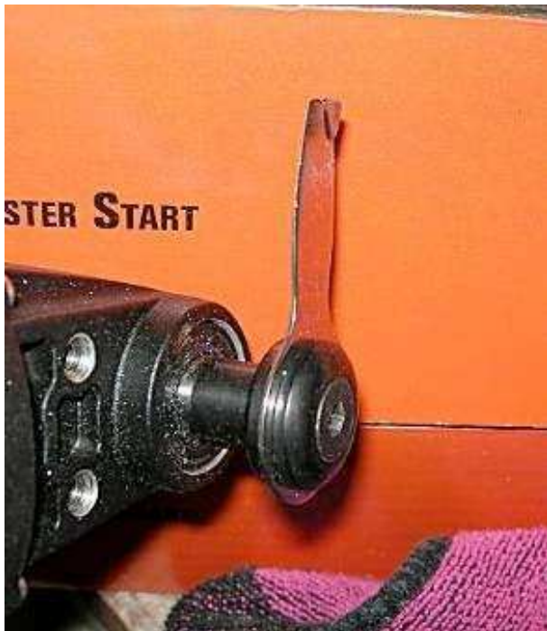
Afb. 5 Fein mesje voor verwijderen rubber
