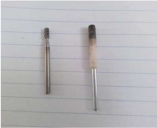
Afb. 13 Dremel frees (3,2 mm) en slijpsteentje (4 mm)
