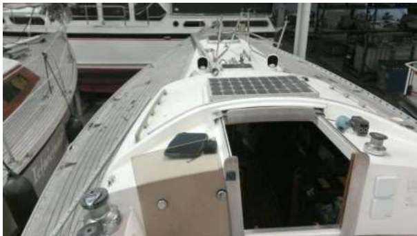
Afb. 2 Bakboord kant, scepterpotten en puttings zijn eraf, de genuarail nog niet
