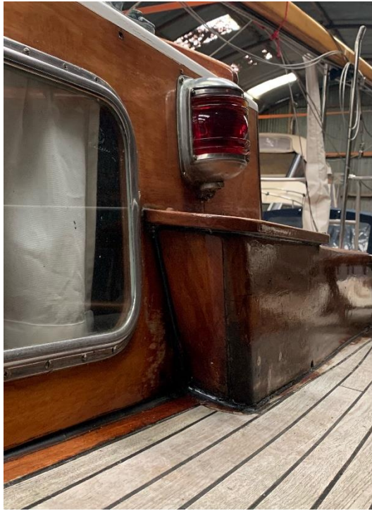
13. Degelijke afsluiting door 'infrezen' van plankje aan voorzijde van de klos.
