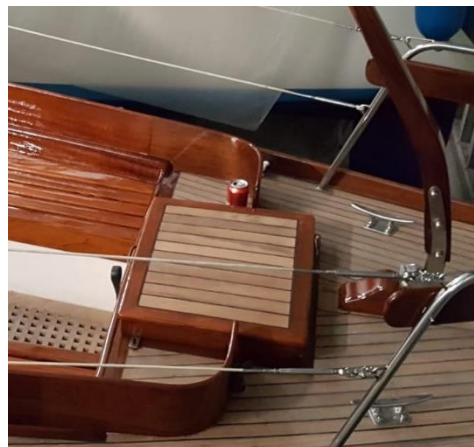
6. Bochtstuk verwijderd. Attentie voor schuine zaagsnede aan de plank. Hiermee creëer je een groter en sterker lijmoppervlak.
