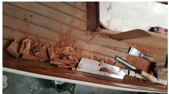
6. Bochtstuk verwijderd. Attentie voor schuine zaagsnede aan de plank. Hiermee creëer je een groter en sterker lijmoppervlak.
