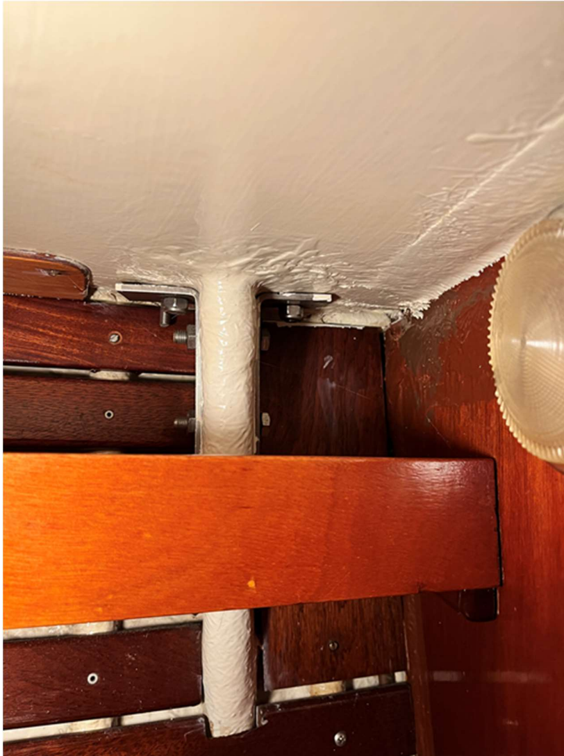
Beugels aangebracht bij SB-voor onderwant
