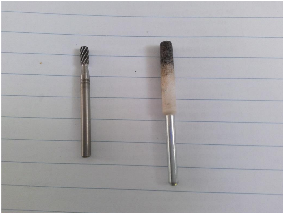
Afb. 13 Dremel frees (3,2 mm) en slijpsteentje (4 mm)
