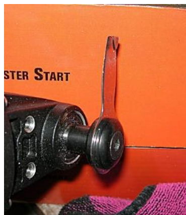
afb. 5 Fein mesje voor verwijderen rubber
