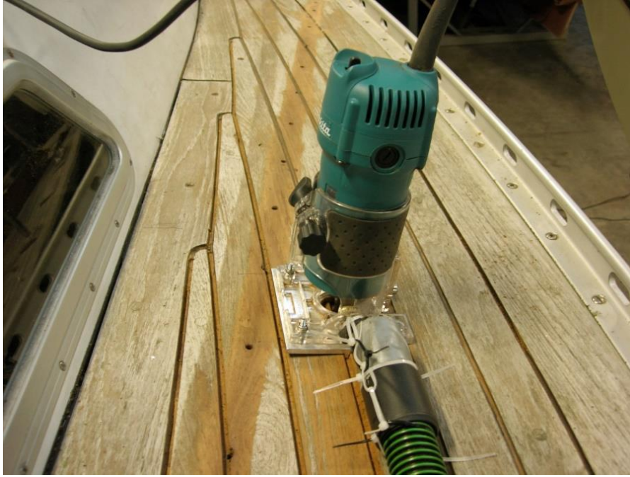
Afb. 11 Frees met stofzuigerslang, voor afzuigen materiaal
