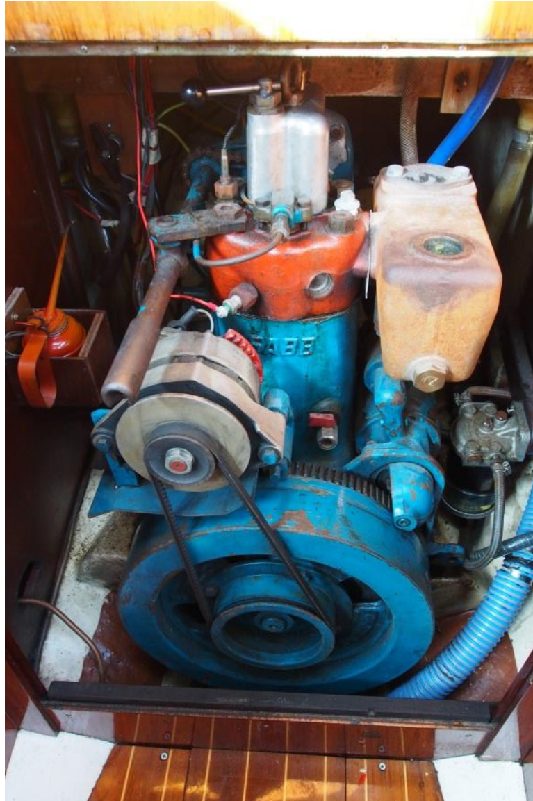
3.7.De originele Sabb dieselmotor
