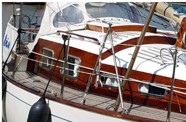
Mit einer Mastlegevorrichtung erweitern sie Ihr Segelgebiet. Diese neue TI gibt zeigt ein Anwendungsbeispiel für den Einsatz und Betrieb auf einer Trintella Ila. Außerdem werden Tipps für die Installation einer neuen Mastlegevorrichtung gegeben.
