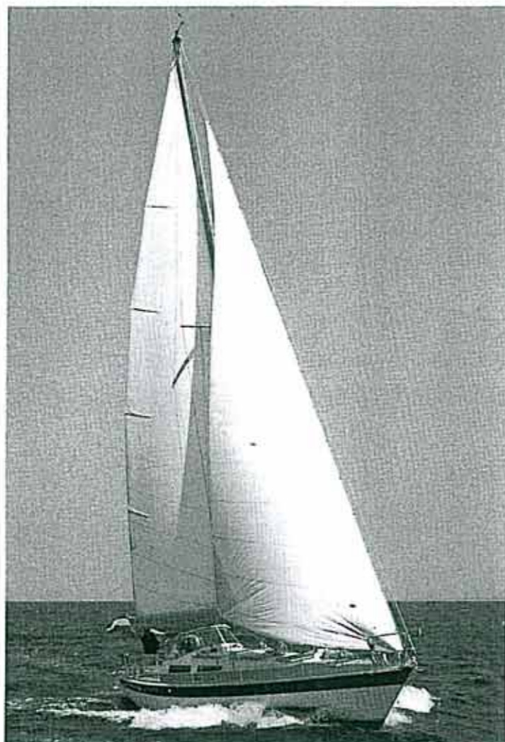
Dank des hohen Mastes kann das Schiff große Segelfläche führen – wegen der guten Stabilität auch bei viel Wind.
