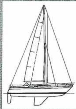
Länge über alles 12,90 m; Länge Wasserlinie 10,60 m
