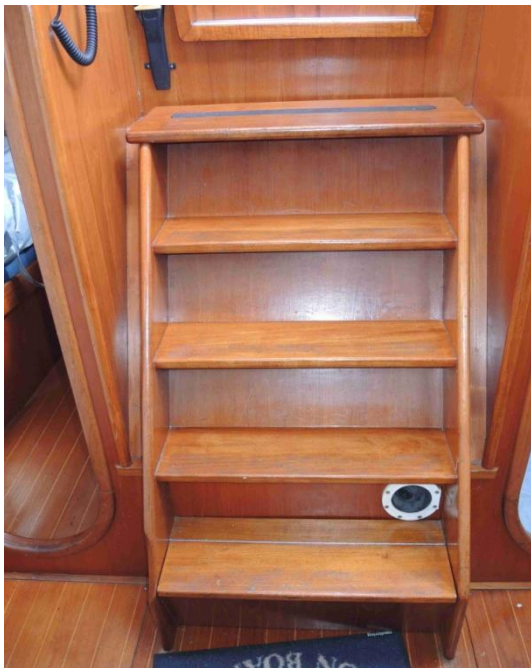
Opening motorruimte afgesloten door vastgeschroefde trap. De trap wordt alleen weggenomen voor onderhoudswerkzaamheden.
