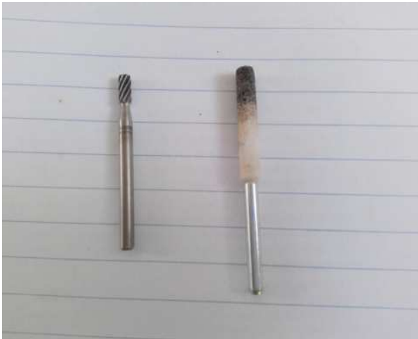
Afb. 13 Dremel frees (3,2 mm) en slijpsteentje (4 mm)
