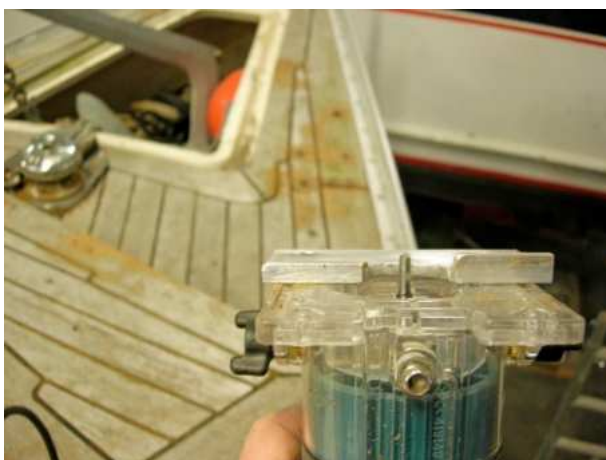
Afb. 9 Freesmachine (op de kop) met frees en gemonteerd hulpstuk
