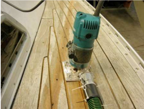
Afb. 11 Frees met stofzuigerslang, voor afzuigen materiaal
