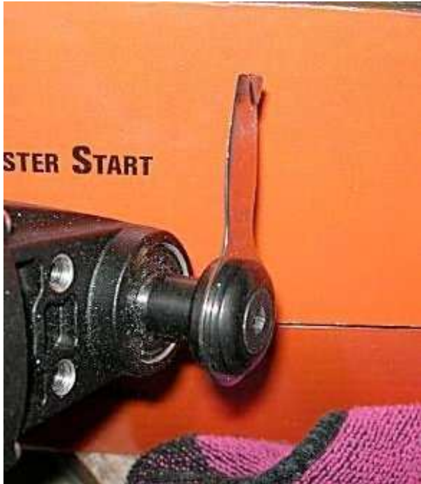
Afb. 5 Fein mesje voor verwijderen rubber
