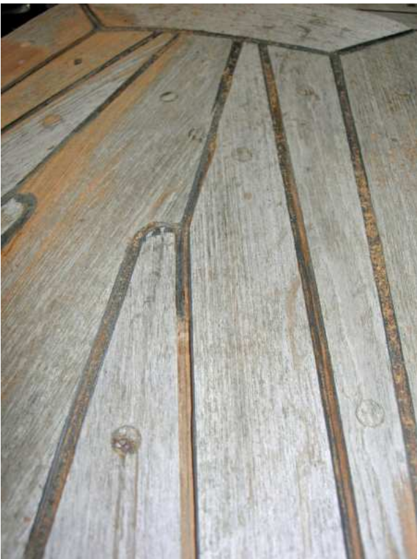
Afb. 12 Eerste groef gefreesd, en een scherpe bocht te zien
