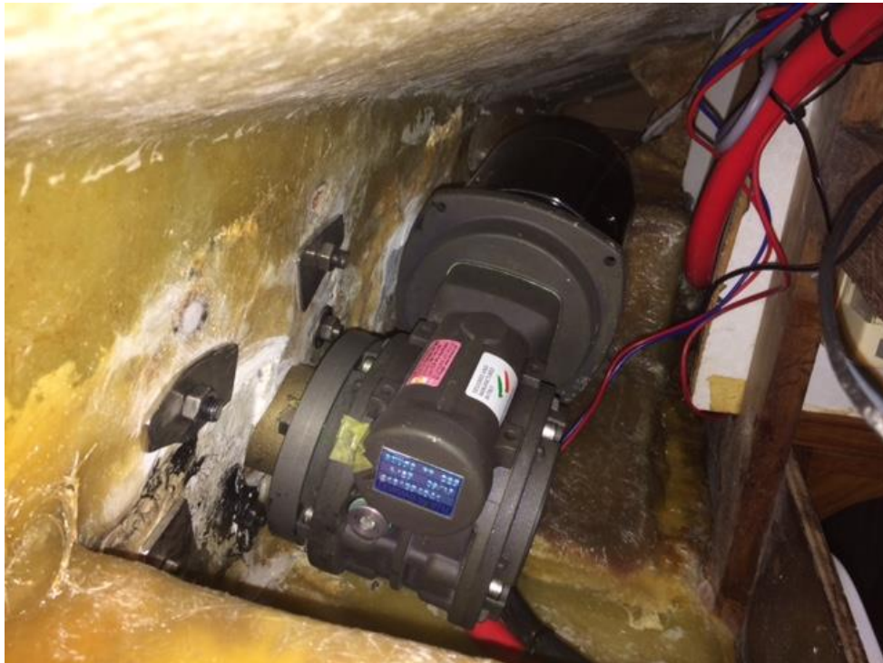
Aandrijving gemonteerd -1. Let op stevige contraplatten
