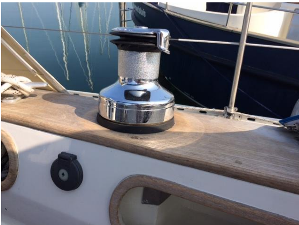
De elektrisch schootlier Lewmar EVO 50 met bedieningsknop
