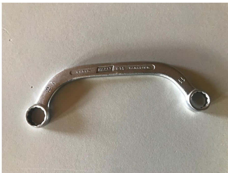
Speciale ringsleutel voor makkelijke bereikbaarheid in krappe ruimte
