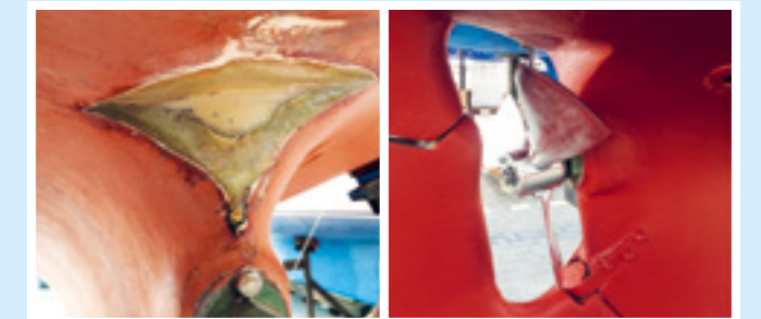
Rompaanpassing voor nieuwe schroef
