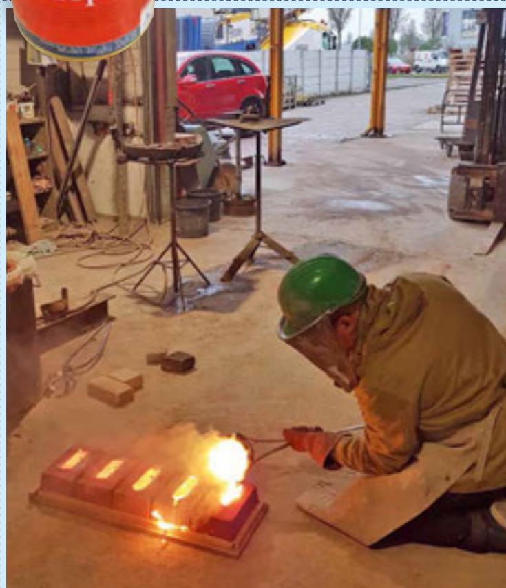
Het gieten van brons (1200 C) in de mallen
